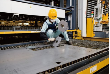
加工が終了したワークを銅板から外していく。6kWファイバレーザでは、厚さ25mmまでの銅板を加工している。
