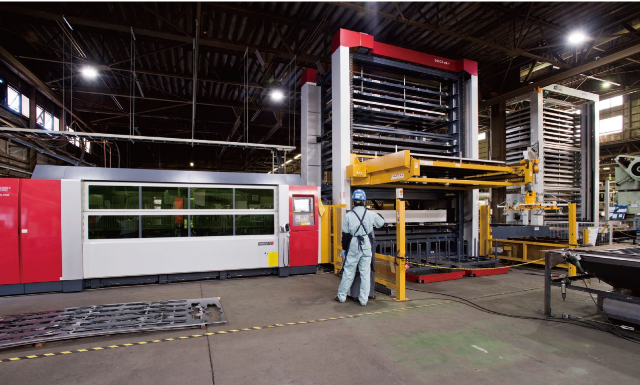
「ML3015eX-F60」と一緒にストックシステム(写真中央)と24段の素材棚(右端)も導入した。ストックシステムは素材をレーザ加工機に自動供給し、加工が終了した製品を加工機から自動搬出。ストックシステムの素材は材料棚からハンディーローダで供給される。
